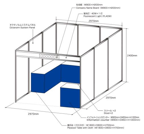
ブースサイズ : W2970mm×D2970mm×H2400mm (オクタノルムシステムパネル)
