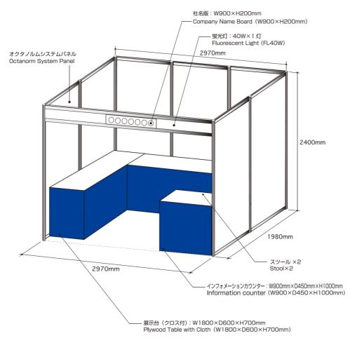
ブースサイズ : W2970mm×D1980mm×H2400mm (オクタノルムシステムパネル)
