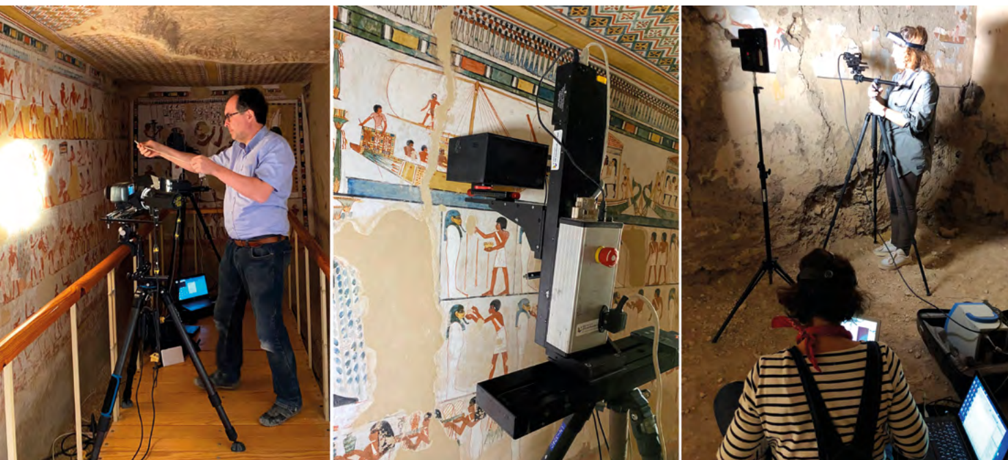
Utilisation du laboratoire portable dans des chapelles peintes de Thèbes-Ouest : à gauche, imagerie multispectrale, au centre XRF, à droite, Raman.
