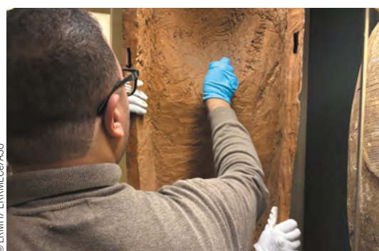
Prélèvement par frottis à l'intérieur d'un cercueil pour quantifier les spores fongiques présentes.
