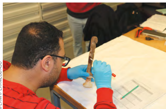
Prélèvement par frottis à la surface d'un ouchebti pour déterminer la quantité de spores fongiques présentes.
